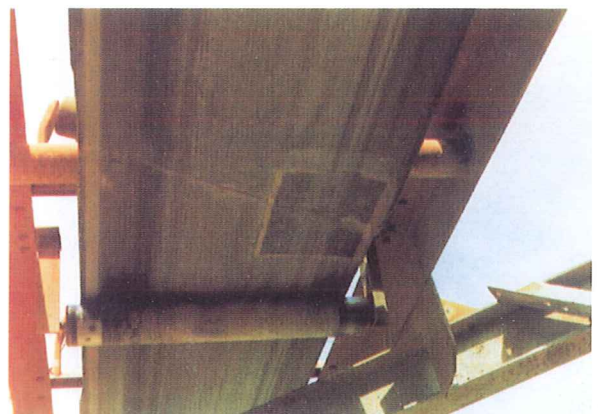
エンドレスした部分のメクレモパッチ1枚で完全修理できます。
